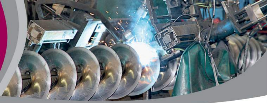
Boruya Kaynaklı Helezon Krom ve Siyah Carbon Steel Or Stainles Steel Screw Flight Welded On Shaft / Pipe حلزون النقل ملحوم على بوري معدني
