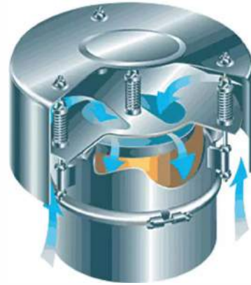
Basınç Emniyet Valfi Pressure Relief Valve صمام إعادة الضغط
